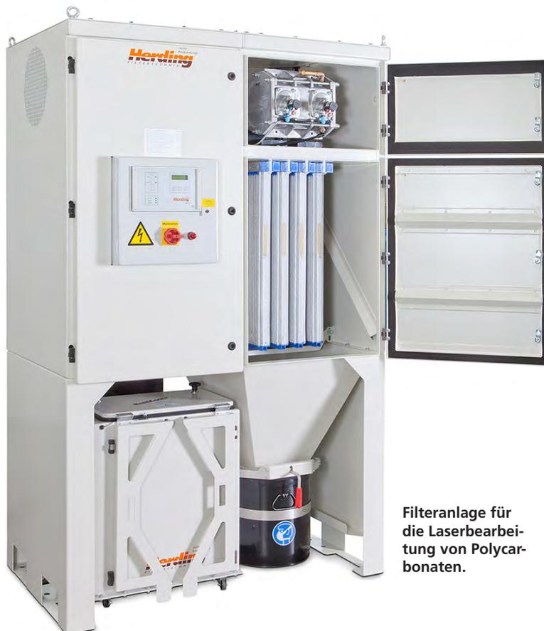
Filteranlage für die Laserbearbeitung von Polycarbonaten.
