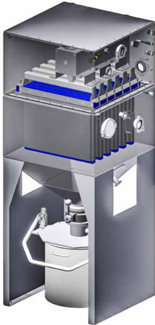
Filterbaugruppe einer Herding® Filteranlage zur Additiven Fertigung. Maximierte Produktivität und Sicherheit durch reine Oberflächenfiltration und Passivierung reaktiven Staubs und Schmauchs.
