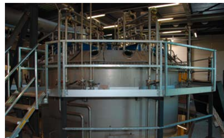
Im Extrakter wird der befeuchtete Tee mit dem Lösungsmittel Methylenchlorid entkoffeiniert.
