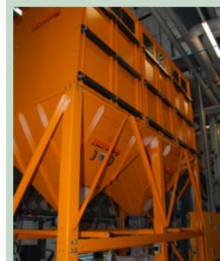
Wöchentlich muss die Filteranlage bis zu 750 kg Teestaub auffangen.
