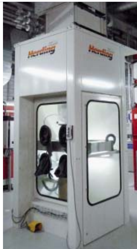
Der Staubaustrag erfolgt kontaminationsfrei in das CLS. Die Abfüllanlage ist zusätzlich ein-gehaust, um das Personal zu schützen.
