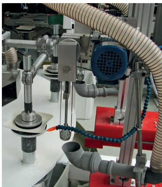
Bild 3 Absaugung Schleifstation am Putztisch nach Iso-Press
