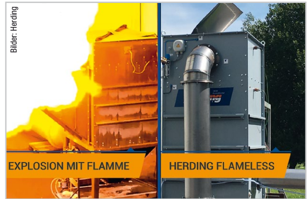
Die flammenlose Druckentlastung Herding Flameless hält auch Rauch und Staub zurück.
