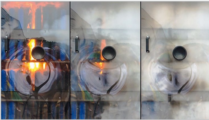
Das Sicherheitskonzept Herding Flamebreak erstickt Flammen in der Filteranlage frühzeitig.
