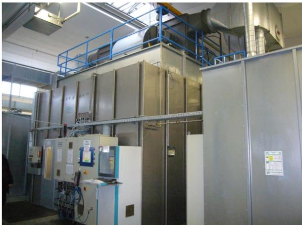
Abb. 1: Realisierte Trockenabscheidung von Nasslacken
