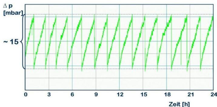
Der Druckverlust des ALPHA-Filters bleibt konstant. Die oben dargestellten Kurven zeigen das Betriebsverhalten bei Precoating und Zyklusabreinigung über 24 Stunden. Die Gastemperatur am Filtereintritt lag während der Aufzeichnung zwischen 380 und 420° C.
